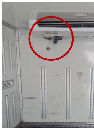
Imagen 1. Ubicación del datalogger en el punto mas caliente.
